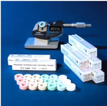
Кольца для Контроля Температуры (ККТ) – высокоточные индикаторы температуры, внешне представляющие собой керамические кольца, способные изменять свои геометрические параметры в зависимости от количества поглощенного тепла. ККТ воспринимают как радиационное, так и конвективное тепловое воздействие. Результат воздействия выражается в виде одного числового параметра – «температуры кольца», который удобно использовать для практических измерений.
