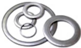
герметизации ввертных гильз с присоединительными поверхностями на месте установки и для уплотнения термопреобразователей в гильзе. Материал: медь М1. Прокладки поставляются в неотожженном состоянии. Перед установкой их следует отжечь при температуре  $600^{\circ}\text{C}$ . Применяют медные прокладки при температуре от  $-253^{\circ}\text{C}$  до  $+250^{\circ}\text{C}$
