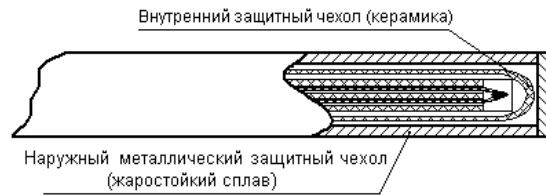
Конструкция рабочей зоны термопреобразователей ТППТ(ТПРТ) 01.06 и 01.16, D = 20, 27 мм
