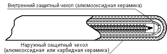
Конструкция рабочей зоны термопреобразователей ТППТ(ТПРТ) 01.22
