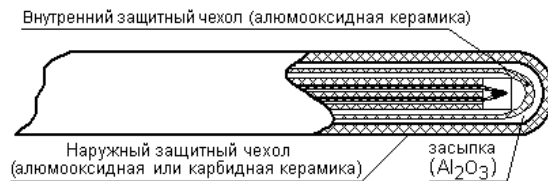
Конструкция рабочей зоны ТППТ(ТПРТ) 01.21
