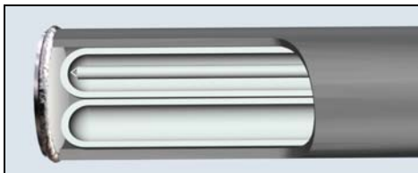
Конструкция рабочей зоны термопреобразователей ТППТ(ТПРТ) 22.06 с двумя внутренними защитными чехлами, один из которых предназначен для установки контрольной термопары.
