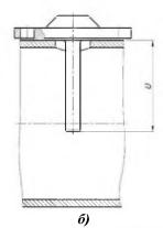
а — резьбовая гильза; б — фланцевая гильза
